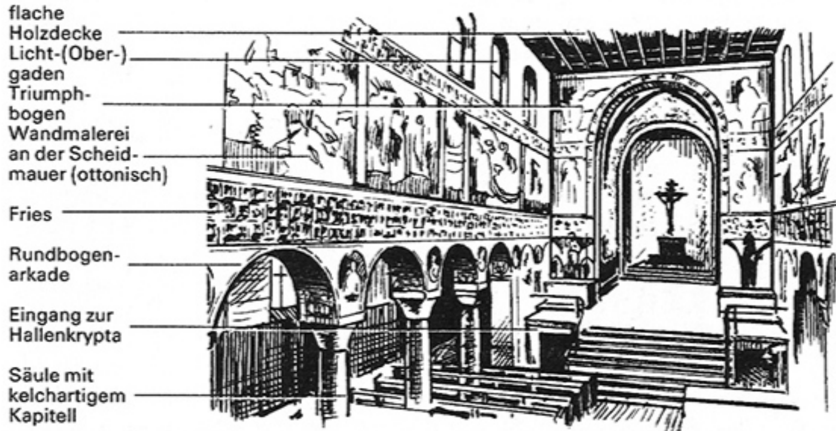
Reichenau-Oberzell, St. Georg, 896–913, spätkarolingische Säulenbasilika, doppelhörige Anlage, erhöhter, eingezogener O-Chor, Zugang zur Hallenkrypta (→ Krypta*) vom Mittelschiff her. Bedeutende Wandmalereien des 10. und 11. Jhs.
